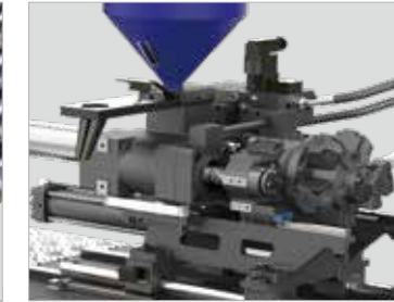
注射全闭环 实现对注射运动的精细化控制，注射精度高，低速稳定性好
