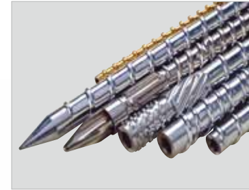
专用塑化组件 PET瓶胚专用高效高混镀铬螺杆，在保证低剪切条件下实现高效优质塑化，改善收缩问题，提升透明度。
